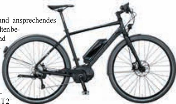
• Spannung: 36 Volt • Kapazität: 11.6Ah • Lithium Ionen, abnehmbar • Ladezeit: ca. 3.5 Stunden • Rahmenhöhen und Farbe 47/51/56 cm, schwarz matt • Gewicht 21,0 kg • UVP 2.599,90 Euro
