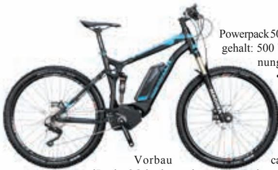
Powerpack 500 • Energiegehalt: 500 Wh • Spannung: 36 Volt
