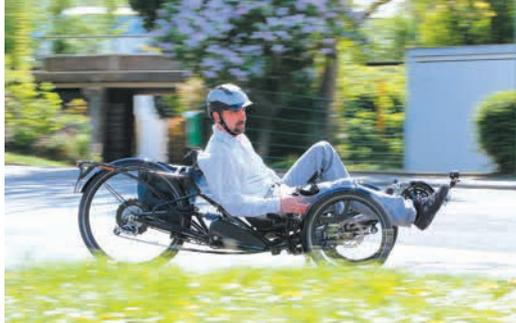
Schwalbe (20“/26“) • Sitzhöhe: 29 cm (BodyLink), 32 cm (ErgoMesh) • Federung (v): McPherson-Federbeine mit Stabilisator (60 mm); Federung (h): DNM DV22 Stahlfeder/Öl (80 mm) • Bremse (v): Tektro Auriga Twin (Scheibenbremsen gekoppelt, mit Ölstandkontrollanzeige von HP Velotechnik; Bremse (h): Tektro Auriga plus Shimano V-Brake (als Feststellbremse mit Rasthebel) • Antrieb: SRAM GX 30 (30 voll schaltbare Gänge; Kassette PG 1070
