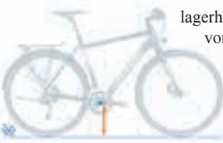
lagerhöhe auch direkt von der Laufrad- und Reifen-dimension abhängt, ist auf den Wert der Innenlagerab-senkung (oft engl. "BB drop") zu achten, der den vertikalen Abstand zwischen Innenlagermitte und der die Achsen verbindenden Waagerechten angibt.
