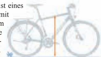
Sie wird vom Boden bis zur Oberkante des Oberrohrs in dessen Mitte gemessen - weshalb sie nur beim klassischen "Herrenrad" zum Tragen kommt, während beim klassischen "Damenrad" Auf- und Absteigen durch das tiefe Oberrohr vereinfacht werden. Im direkten Vergleich von Überstandshöhe und Innenbeinlänge des Fahrers sieht man, ob man einfach über dem Rad stehen kann. Nötig wird das, wenn man beim Anhalten absteigt, oder in einer Gefahrensituation aus dem Sattel springen muss.
