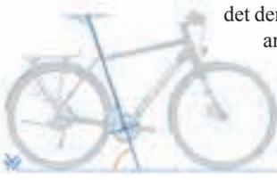
det den steilen Winkel an Zeitfahrrädern und moderner MTB-Geometrie, wo er die mittige Position auf dem Rad begünstigt und Traktion beim Klettern liefert. "Den Sitzwinkel kann man selbst in gewissen Grenzen beeinflussen, indem man den Sattel in der Klemmung der Sattelstütze verschiebt, oder zwischen gekröpfter und gerader Sattelstütze wechselt. So lässt sich die Ergonomie des Pedalierens an die individuelle Länge der Oberschenkel anpassen", wie Stefan Stierer erklärt.
