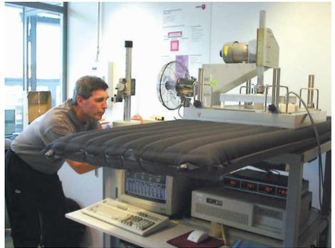
**Exped-Gründer Andi Brun bei der Messung des R-Wertes einer Matte bei der EMPA in Zürich. Brun hat nicht nur die legendäre DownMat entwickelt, er ist weltweit einer der Pioniere bei der Messung des Isolationswertes von Isomatten.**
